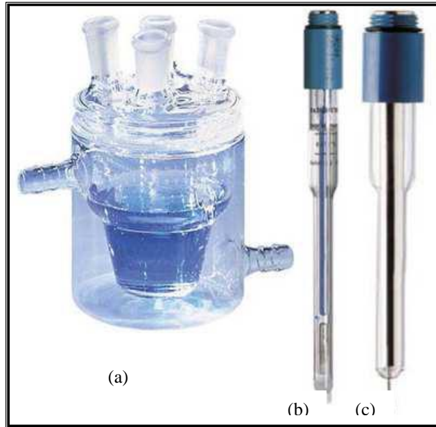
Fig.III.3.2 (a) cellule de mesure, (b) électrode de référence, (c) contre électrode en platine.
