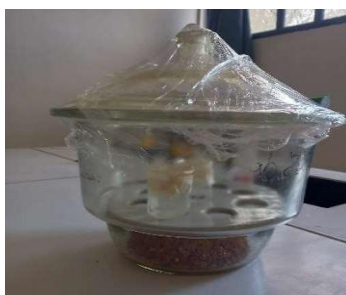
Figure n° 20 : test perméabilité à la vapeur d'eau (photographie prise au laboratoire)
