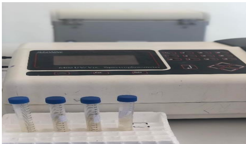
Figure 06: Mesure de la chlorophylle-a et des phéopigments par spectrophotomètre.
