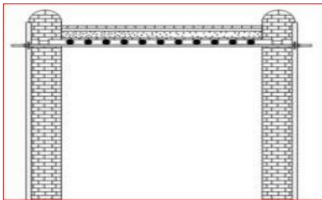
Figure 38 : étaiments des deux côtés du mur Source : PPMVSA
