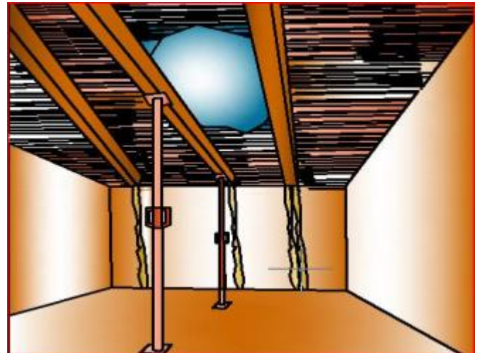
Photo 57 : Etalement de plancher avec des pieds droits - Source : L'auteur
