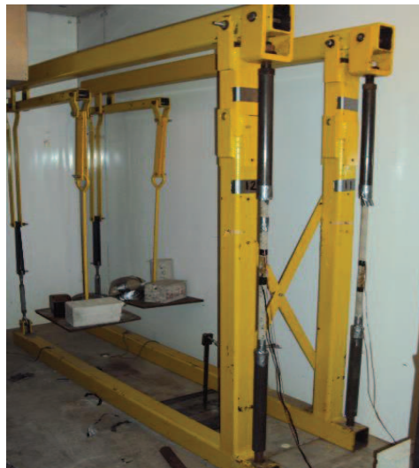
Figure 4.9: Essai de traction conditionné sur des barres en PRFV – Bâti de fluage.
