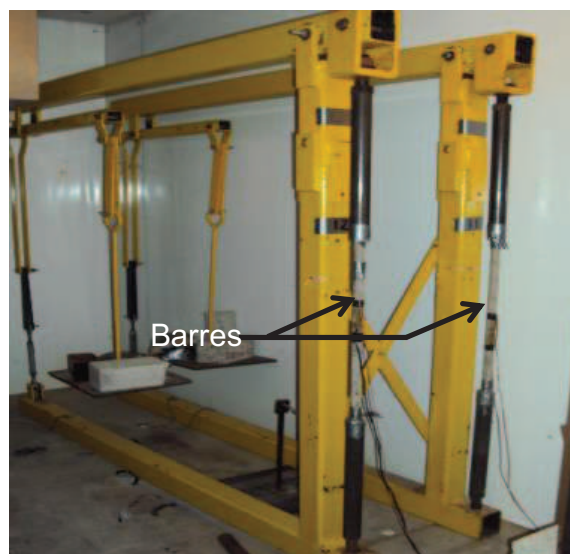
Figure 5.24 : Montage expérimental d'essai de traction conditionné sur les barres de PRFV.
