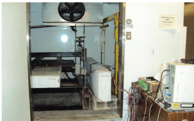
Figure 4.10: Chambre environnementale contenant les dalles SA et SB, et le bâti de fluage.
