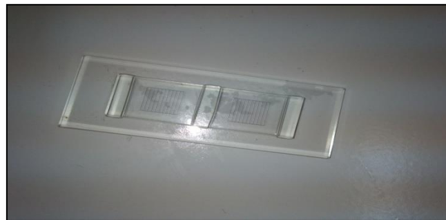
Photo 14: La cellule Mac Master (Photo personnelle, 2017).
