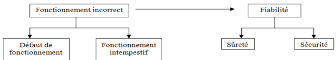
Figure I.12: Fiabilité d'une protection électrique
