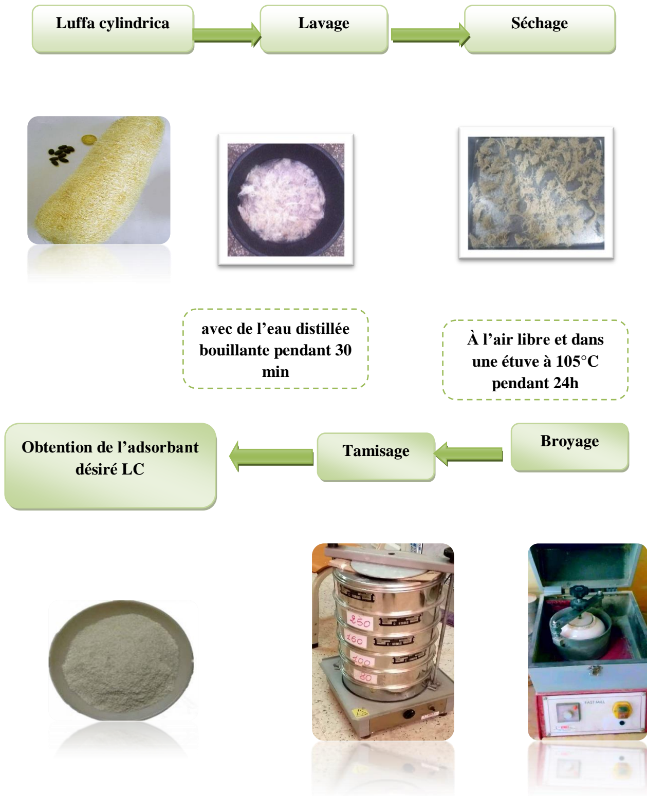
Figure II.1 : Protocol de préparation de l'adsorbant LC.
