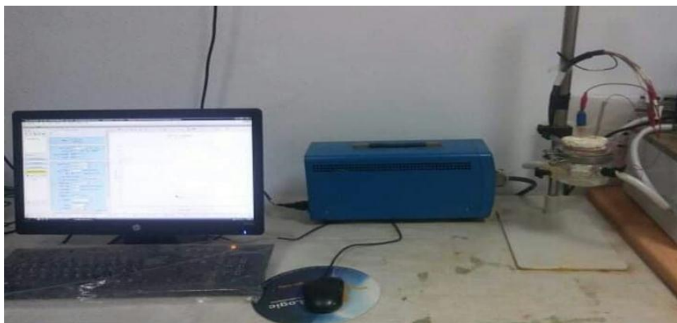
Figure 17 : Potentiostat SP-150 et Cellule électrochimique
