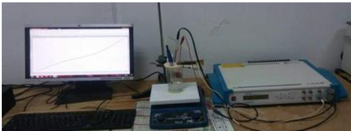
Figure 18 : Photo de potentiostat VOLTALAB 201 et Cellule électrochimique
