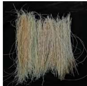
B : fibre des bras de grappe après la séparation
