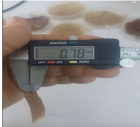
Figure 8. Mesure de l'épaisseur de bioplastiques à base d'amidon et plastique commercial.
