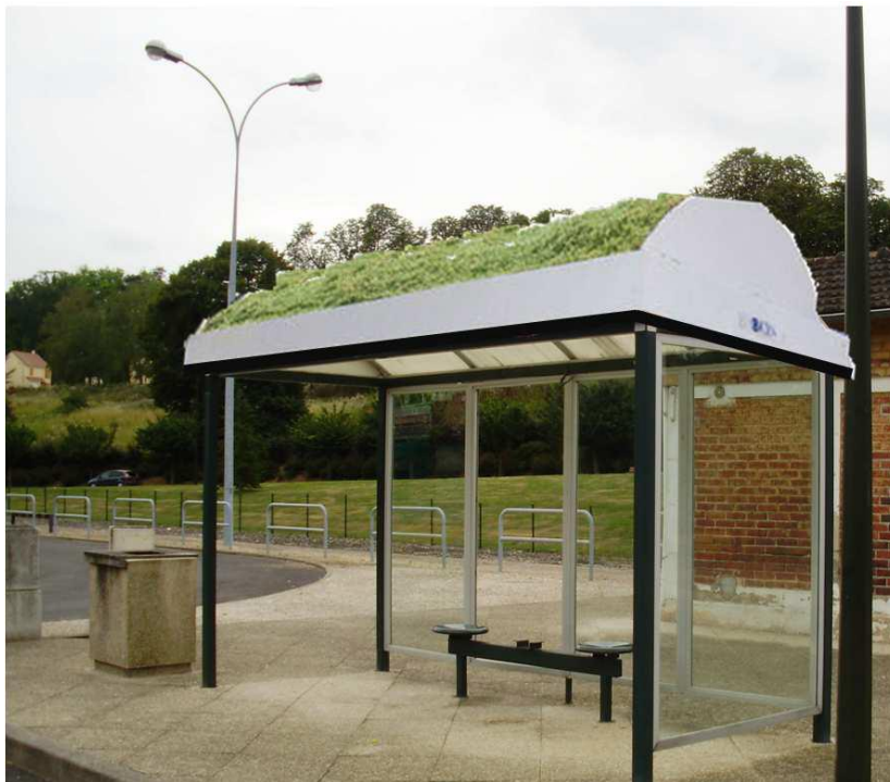
Figure 145: Abribus à toiture végétalisée Source : Guide d'aide à la prescription de mobilier urbain P 72
