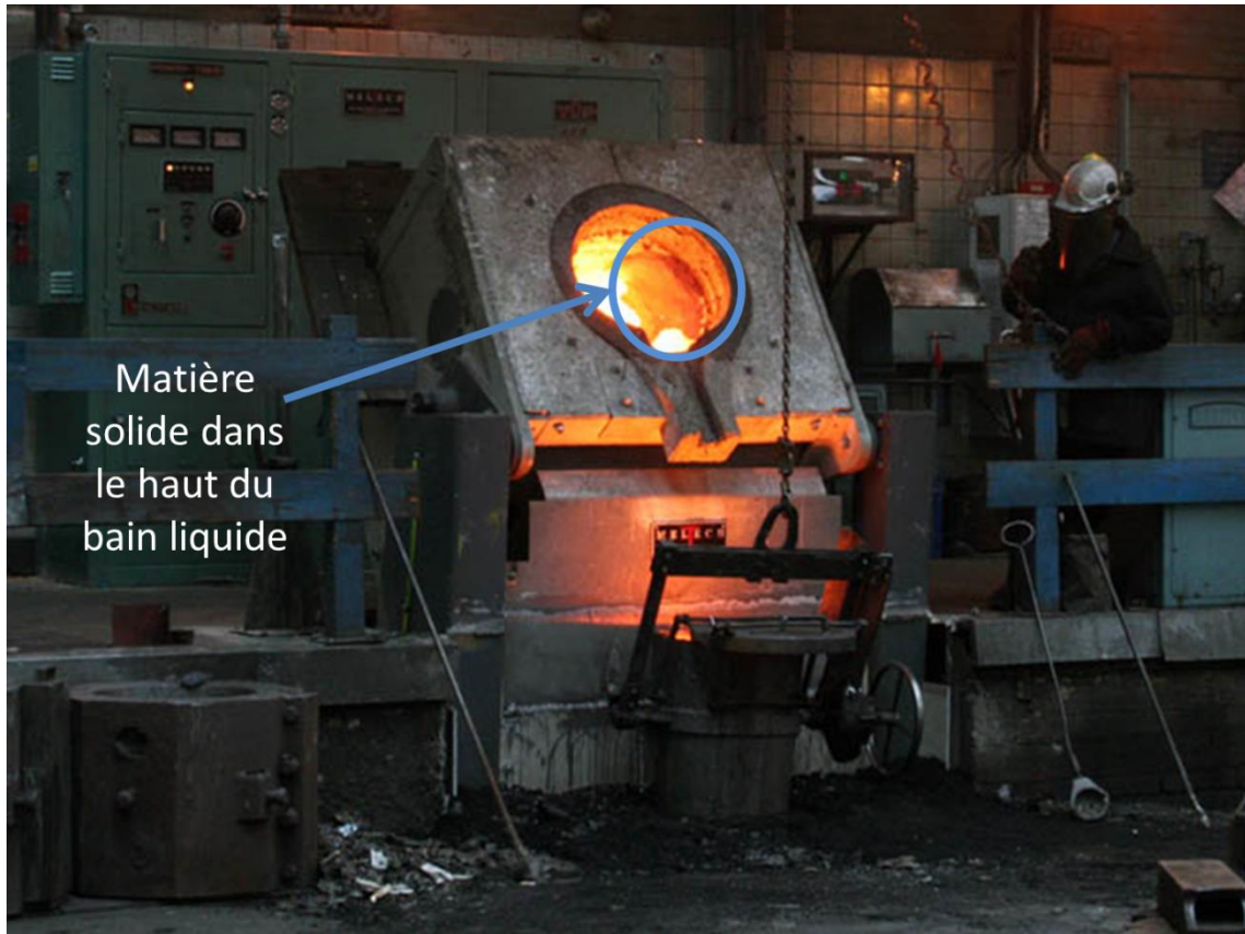
Figure I.4 : Formation de matière solide dans le haut du bain liquide en fusion. D'après la société ATRITOR, Coventry UK.
