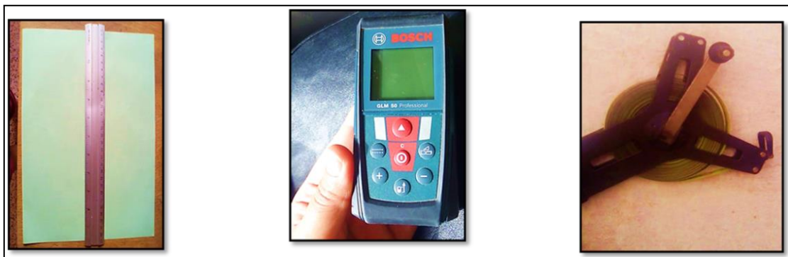
Figure 184: Outils utilisés dans le levage architectural du bâtiment (décamètre 20 m, mesurant 30 cm.) Source: Auteur
