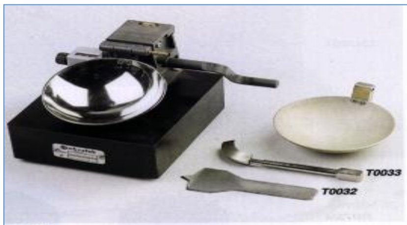
Figure III-2: Schématisation de l'appareil de Casagrande
