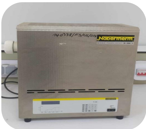
Figure II.4. Four tubulaire (Laboratoire pédagogique département SM -Laghout).
