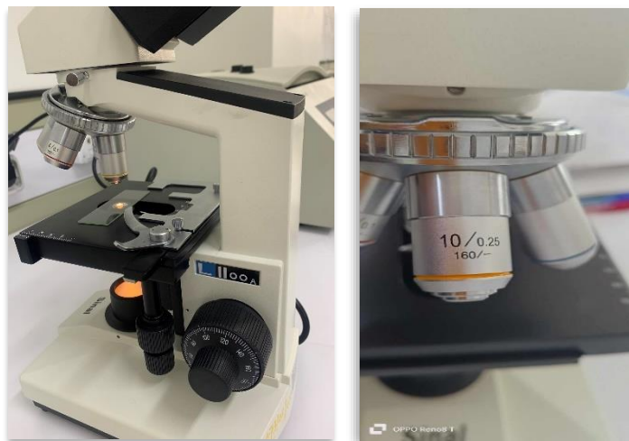
Figure II.8. Le microscope optique avec l'objectif de grandissement ( \times 10 ).
