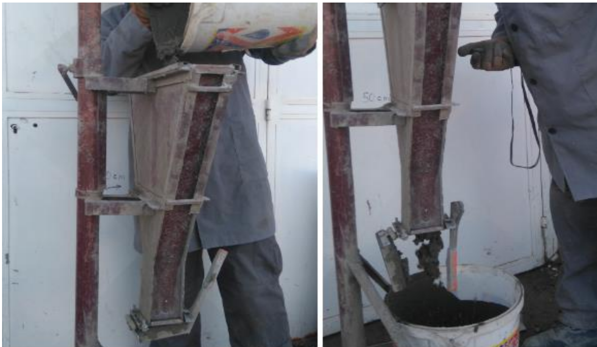
Figure 2. 12 Essai à l'entonnoir en V
