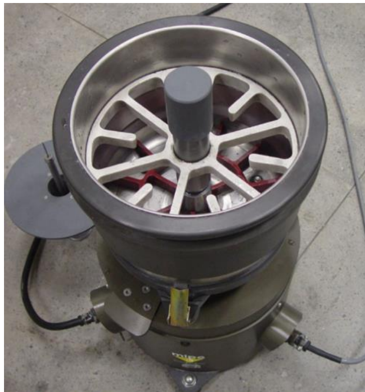
Figure 1. 16 Rhéomètre à béton BT Rhéom (Cordeiro et al. , 2016)
