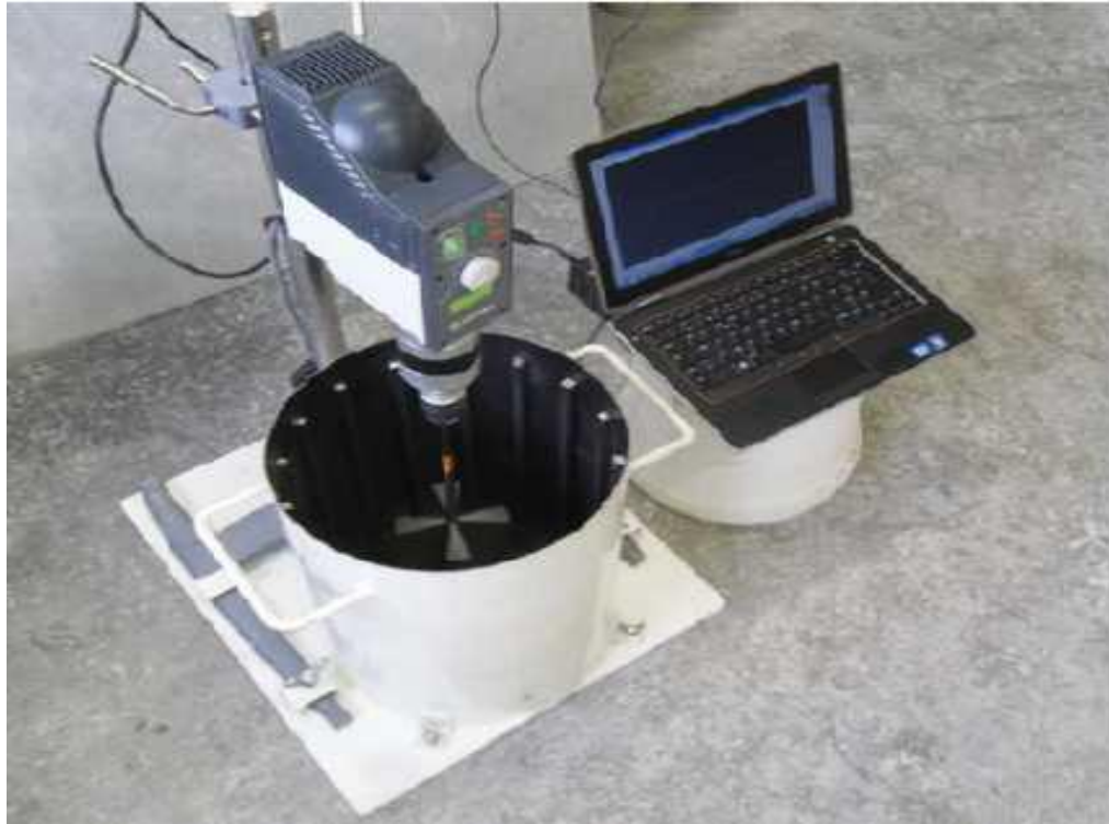
Figure 1. 18 Dispositif du rhéomètre utilisé (Soualhi et al. , 2016)
