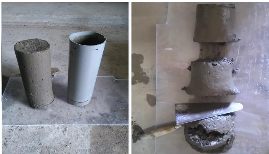
Figure 2. 16 Essai de ségrégation à la colonne
