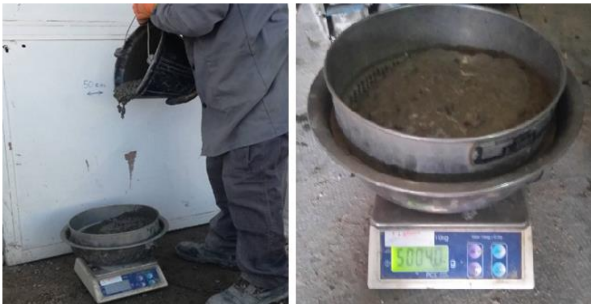
Figure 2. 14 Essai de stabilité au tamis
