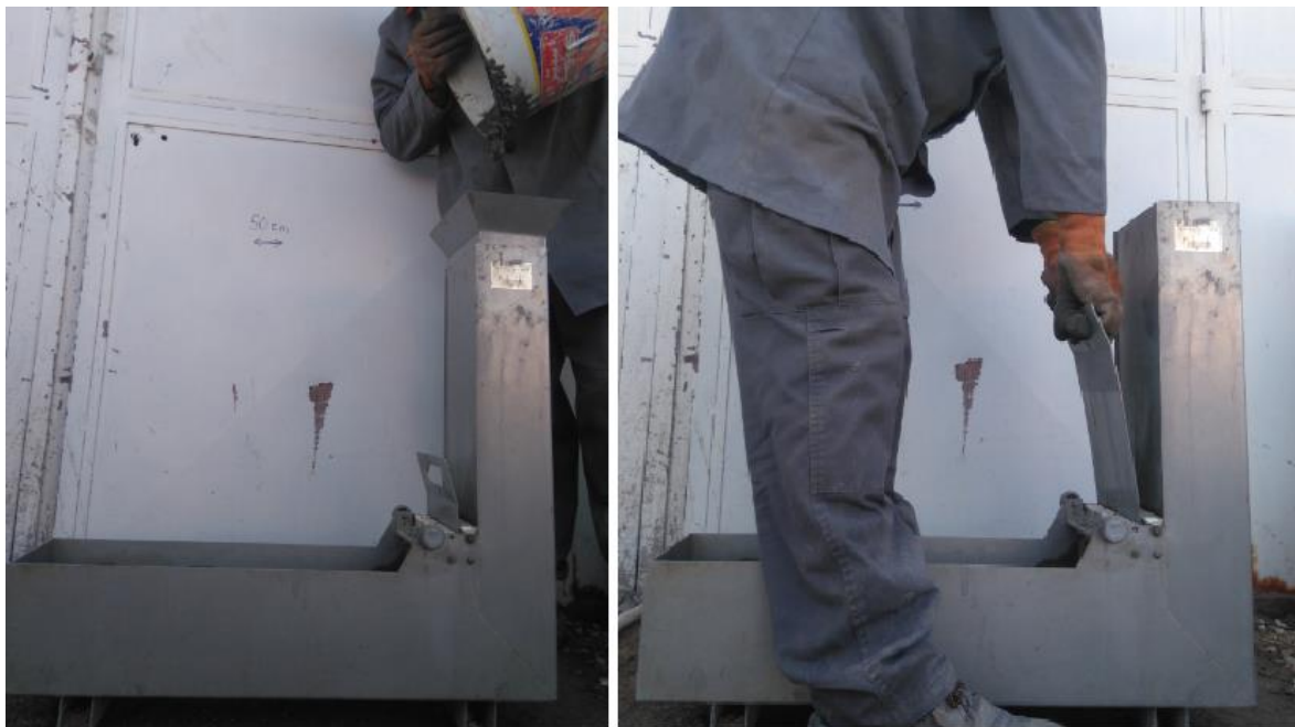
Figure 2. 13 L'essai de la boîte en L
