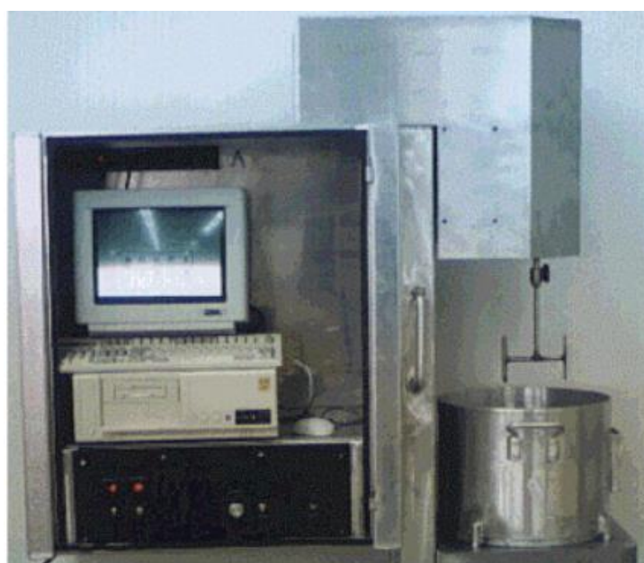
Figure 1. 13 Rhéomètre IBB (Ferraris et al. , 2001)
