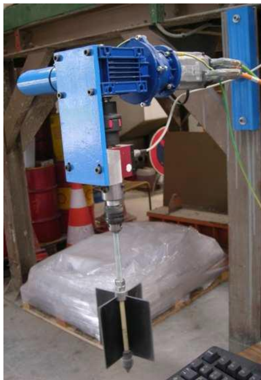
Figure 1. 15 Le rhéomètre du LGCGM (Estelle et Lanos, 2012)
