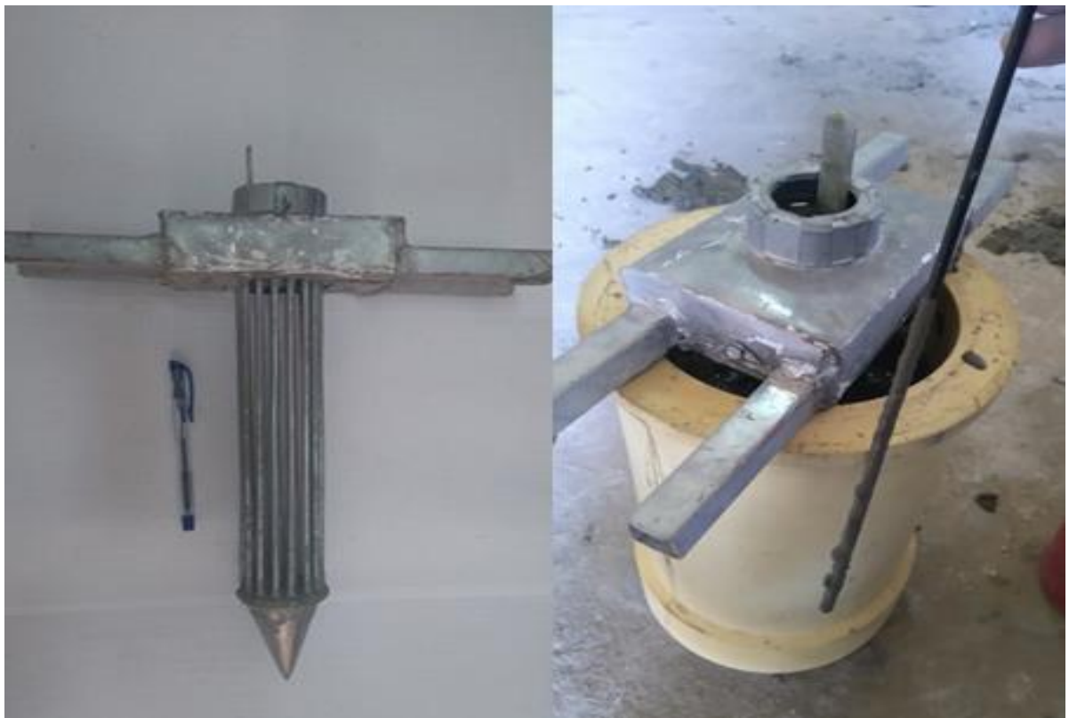
Figure 2. 23 Essai de K-slump modifié
