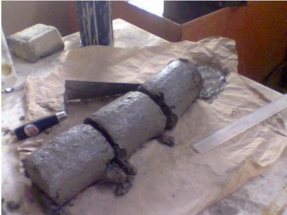
Figure 1. 6 Colonne d'un béton frais pour mesurer l'indice de ségrégation statique (Bensebti et al. , 2015)
