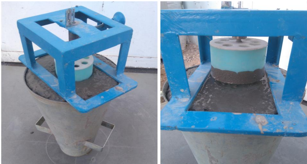
Figure 2. 15 Essai de ségrégation au cylindre
