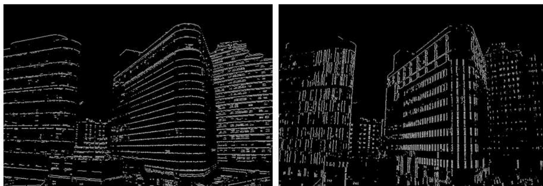
Fig.4. Résultats de simulation de l'application de filtre de Sobel sur une image en Matlab, (a) l'image
