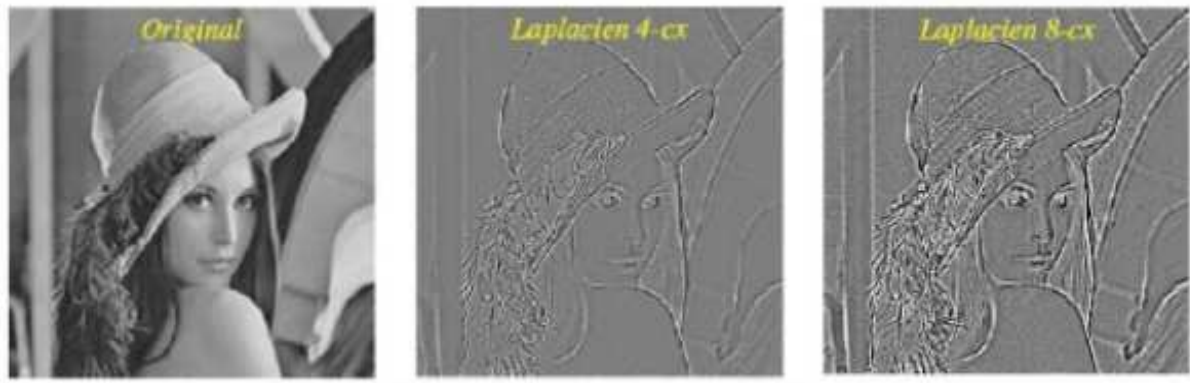
Fig.9. Comparaison entre Laplacien 4 et 8 connexités[7].
