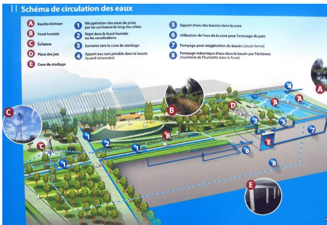
Figure 24 Détails sur la gestion de l'eau dans le parc Martin Luther-King
