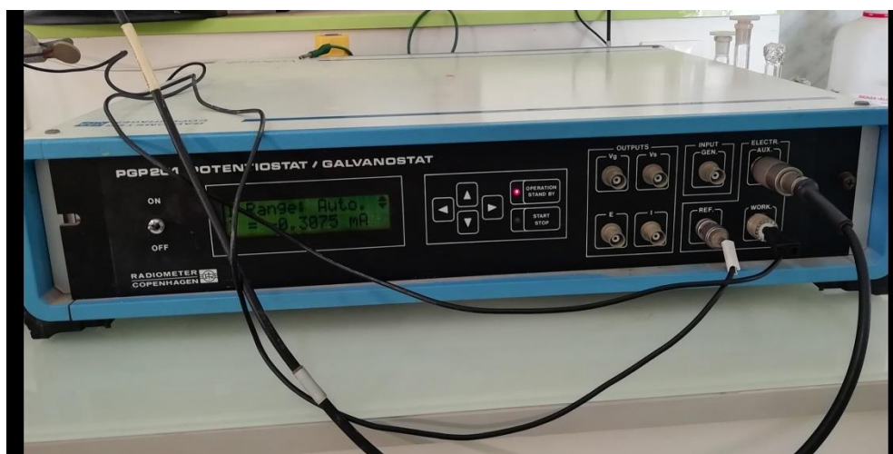
Figure (8) : Photographie des chaînes électrochimiques potentiostat radiometer copenhagen PGP201
