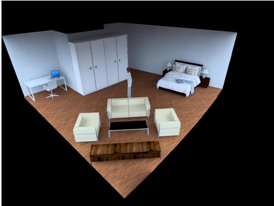
Rendu 14: simulation sur Dialux de l'éclairage naturel le 21 décembre à 15h par ciel couvert (source : auteur)
