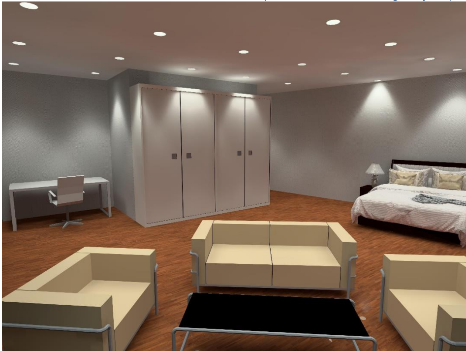
Rendu 28: simulation sur Dialux de l'éclairage naturel le 21 décembre à 15h par ciel couvert après intervention et éclairage artificiel (source : auteur)
