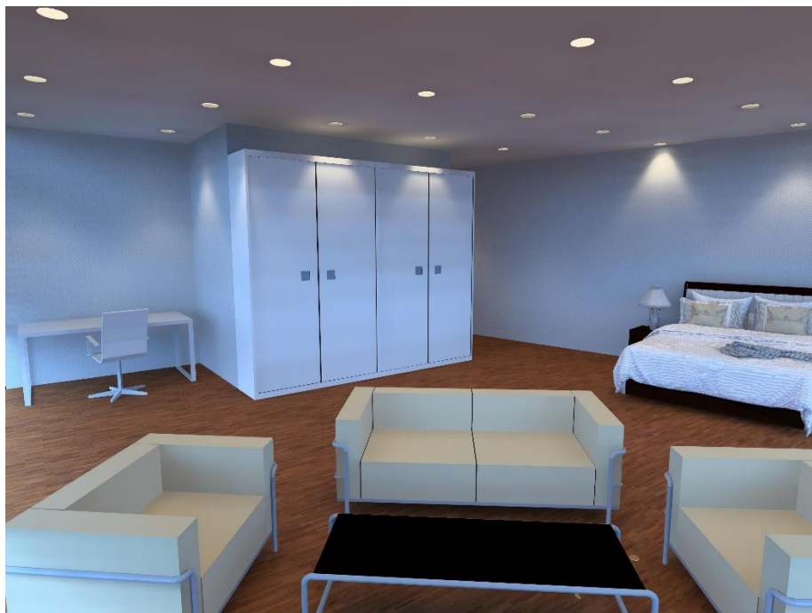
Rendu 26: simulation sur Dialux de l'éclairage naturel le 21 décembre à 15h par ciel couvert après intervention et éclairage artificiel (source : auteur)
