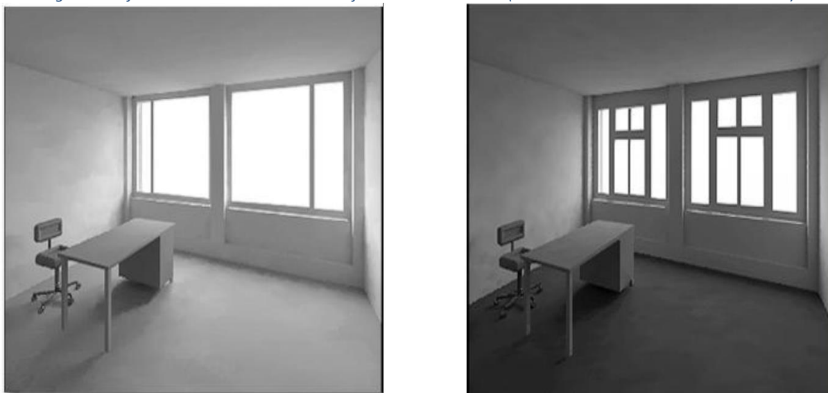
Figure 16: influence des menuiseries sur la surface d'ouverture réelle (source : Bernard PAULE EPFL-ENAC 2007)
