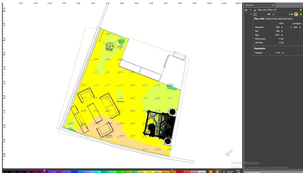
Rendu 18: fausse couleur sur Dialux le 21 juin à 9h par ciel dégagé après intervention (source : auteur)
