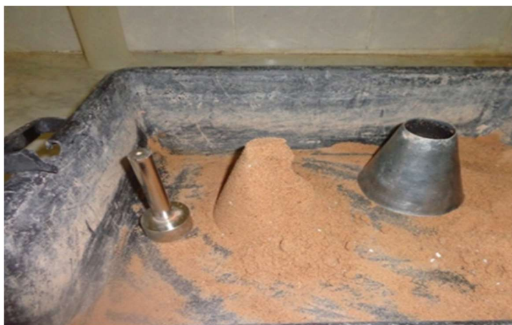
Figure 3.10. Test de pré-séchage avec le cône et le piston.
