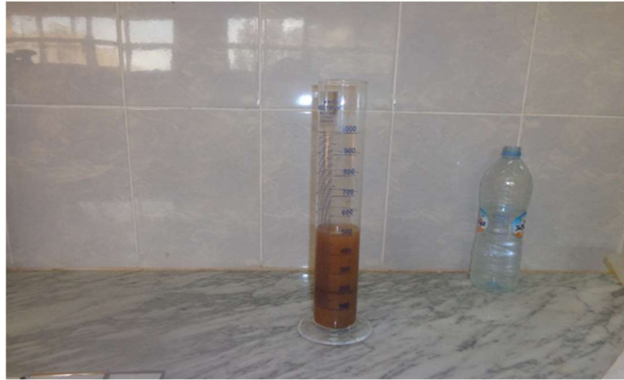
Figure 3.9 Essai de la masse volumique spécifique.
