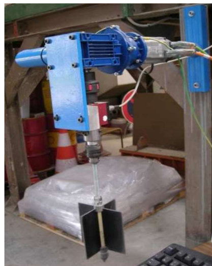
Figure 2.8. Schéma de principe du dispositif expérimental et du rhéomètre à béton [49].
