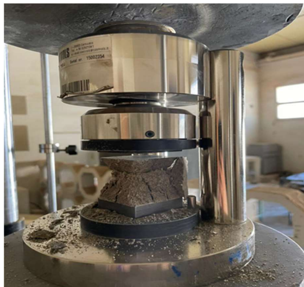
Figure 3.18. Essai d'écrasement des éprouvettes
