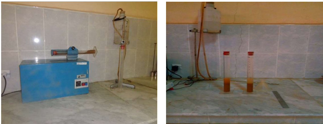
Figure 3.8. Essai de l'équivalent de sable.
