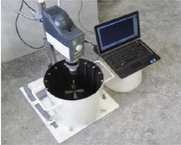
Figure 2.10. Rhéomètre L2MGC et profil de vitesse du rhéomètre Soualhi et al [47].
