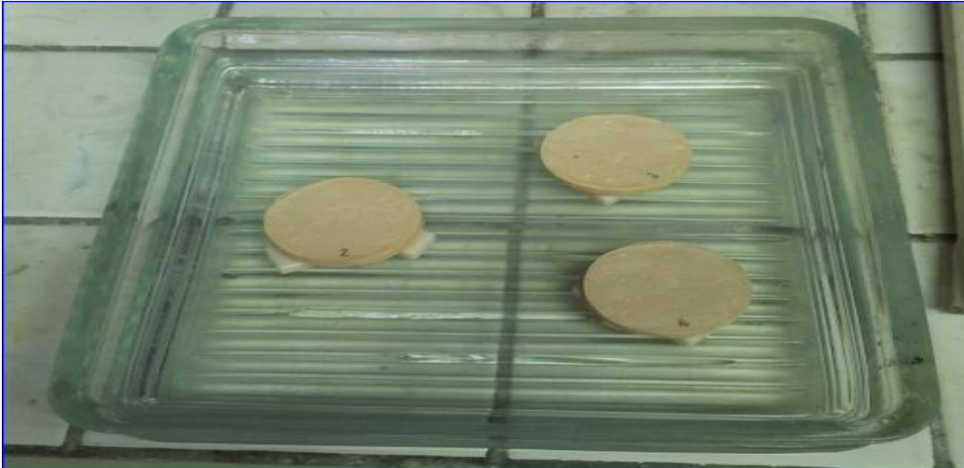
Figure 27 : Test d'absorption d'eau par saturation.
