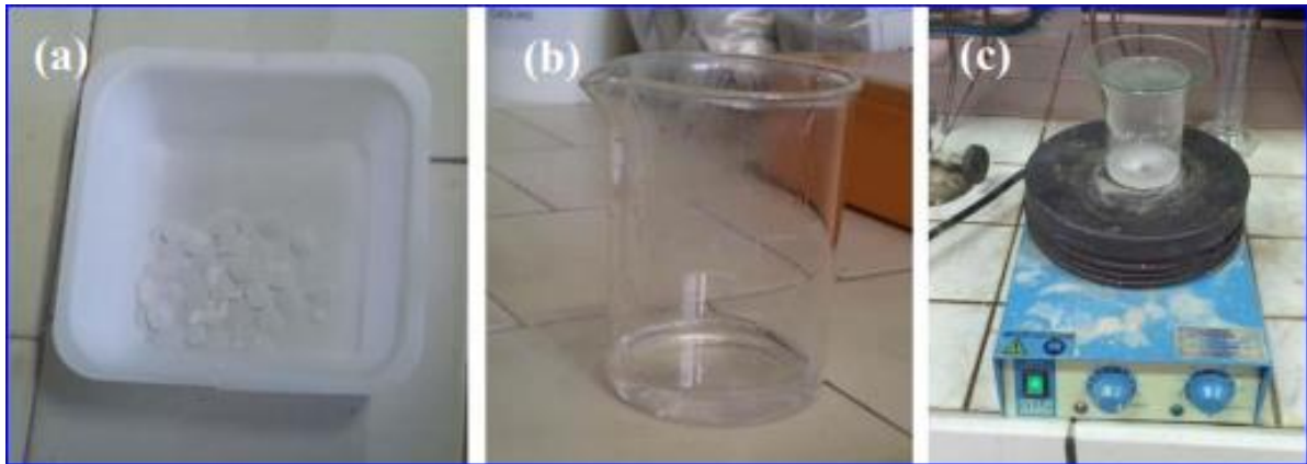
Figure 20 : (a) KOH en pastilles, (b) silicate de Na et (c) agitateur magnétique utilisé pour faciliter la dissolution du KOH dans le silicate de sodium.
