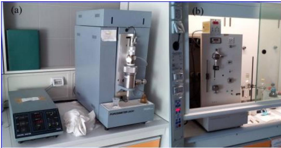
Figure 30 : (a) Unité Micropores et (b) Unités Macropores du porosimètre à intrusion de mercure.
