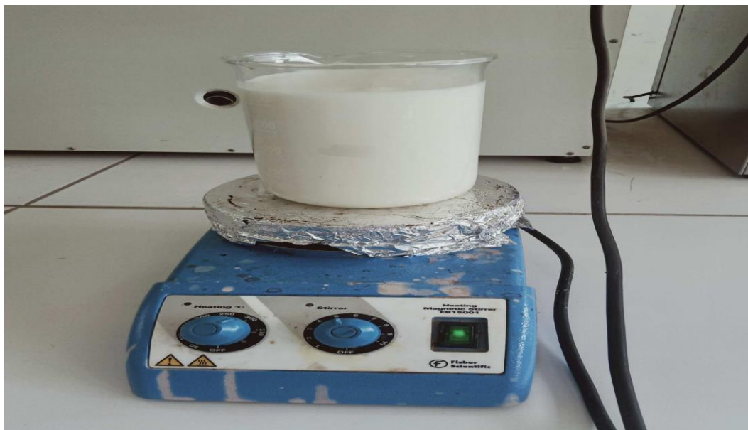
Figure 11 : Photographie originale représente la pasteurisation du lait à l'aide d'une plaque chauffante.
