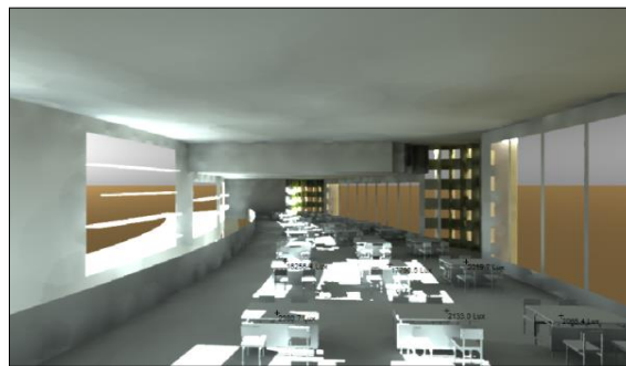
Fig.V. 38 :niveau d'éclairéement a 15h -ciel dégagé- source : Auteur
