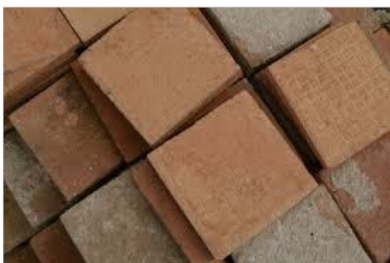
Fig. IV.27: Béton De Terre Stabilisé Source: www.planetecampus.com
