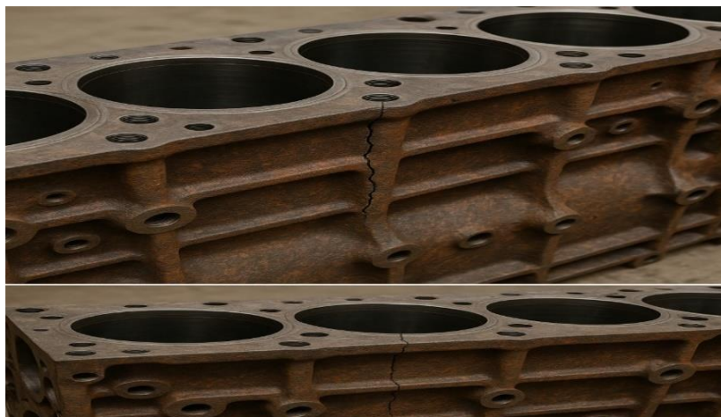
Figure 3.8 bloc moteur fissuré [23]
