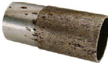
Figure I.8 : Corrosion par piqûres d'un acier inoxydable
