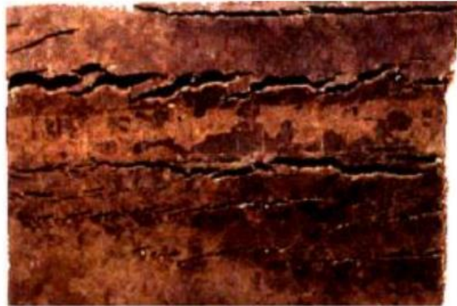
Figure I.13 : Fissures de CSC (15)
