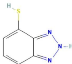
Figure III.5 : Structure moléculaire de l'inhibiteur MBT
