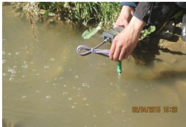
Figure 16: Mesuré in situ par Multi-Paramètre (Original, 2024)
