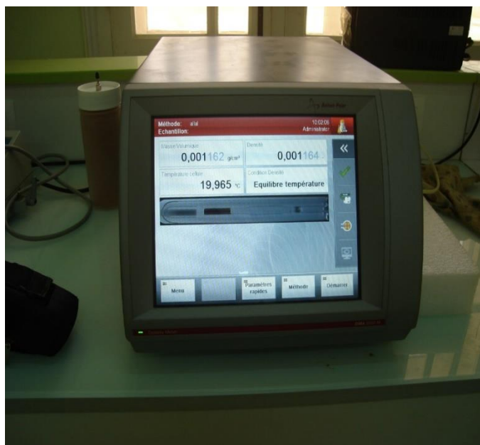
Figure II.2 : Photo du densimètre Anton-Paar 5000 utilisé pour les mesures des densités
