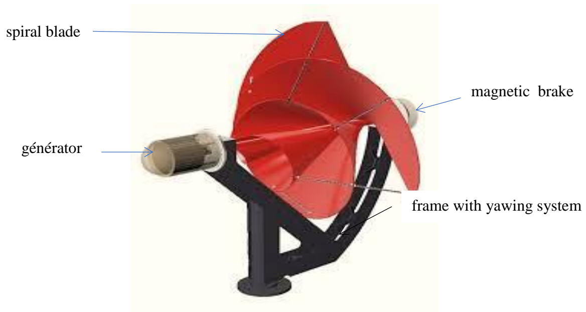
Figure II.3 Composition d'une éolienne Archimède.
