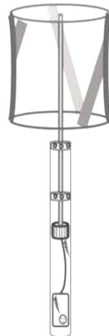
Figure I.5 Architecture d'une éolienne verticale
