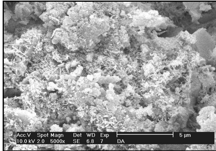
Fig. I. 6. Aspect des hydrates (G=5000)
