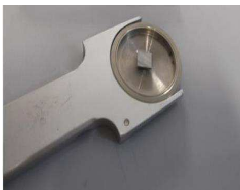
Figure III-15 : Porte échantillon de diffractomètre des rayons X.
