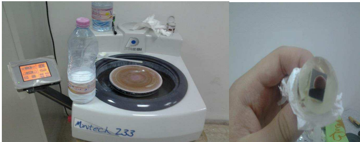
Figure III-9 : Polissage de finition par la feutrine et l'alumine.
