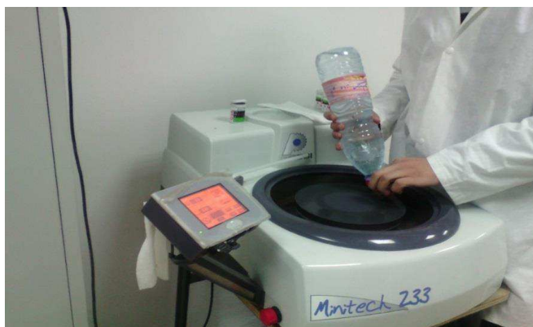
Figure III-8 : Polissage par papier 2000.
