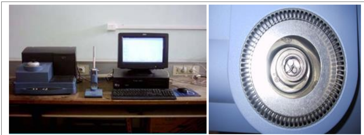
Figure III.3: vue générale du calorimètre DSC Q10 et de son four [1]
