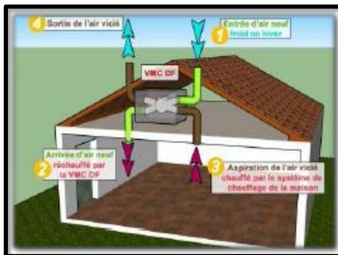
Figure 47 : Ventilation mécanique à double flux.
