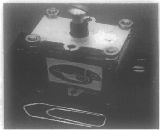
Fig II. 3: Actionneur MSM linéaire d'Adaptamat ©, course # 0.6mm, Force bloquée # 3N, F_{max} 300Hz, M= 60g .
