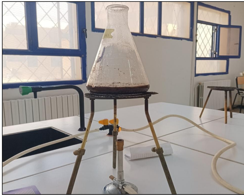
Figure 5: Bouillage de caroube trempée (chaque sirop a une température et durée d'extraction).
