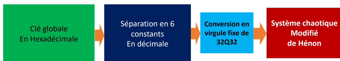
Figure.3.7 : Le schéma de processus de génération de paramètres de contrôle à partir de la clé globale de système.
