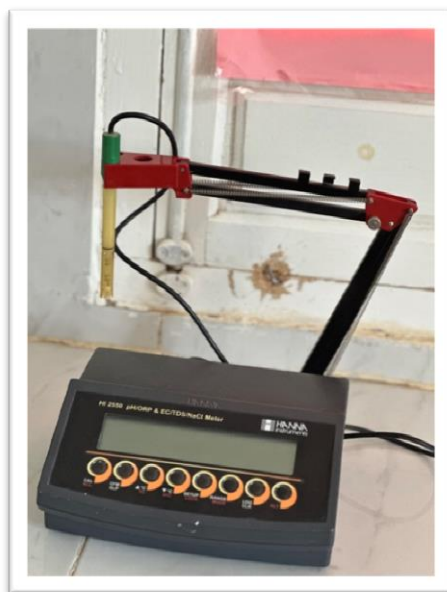
Figure 13 : Conductivité mètre pour mesure la conductivité et TDS HANNA INSTRUMENTS 2550
