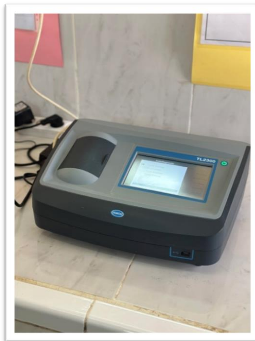
Figure 14: Turbidimètre de paillasse HACH COMPANY pour mesure de la turbidité
