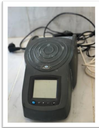
Figure 17: SPECTROPHOTOMETER ILLUMINATOR MODULE HACH COMPANY BOX 389 de détermination des teneurs en nitrates
