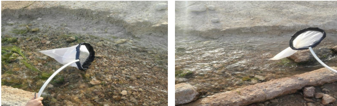
Figure11: Echantillonneur de type Troubleau (manuelle) (Originale.2020)
