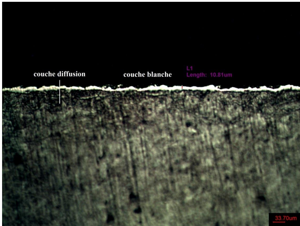
Figure 3-3- Micrographie optique d'une section droite de l'échantillon de l'acier 55CrMoV4, nitruré à 550°C pendant 12 heures.
