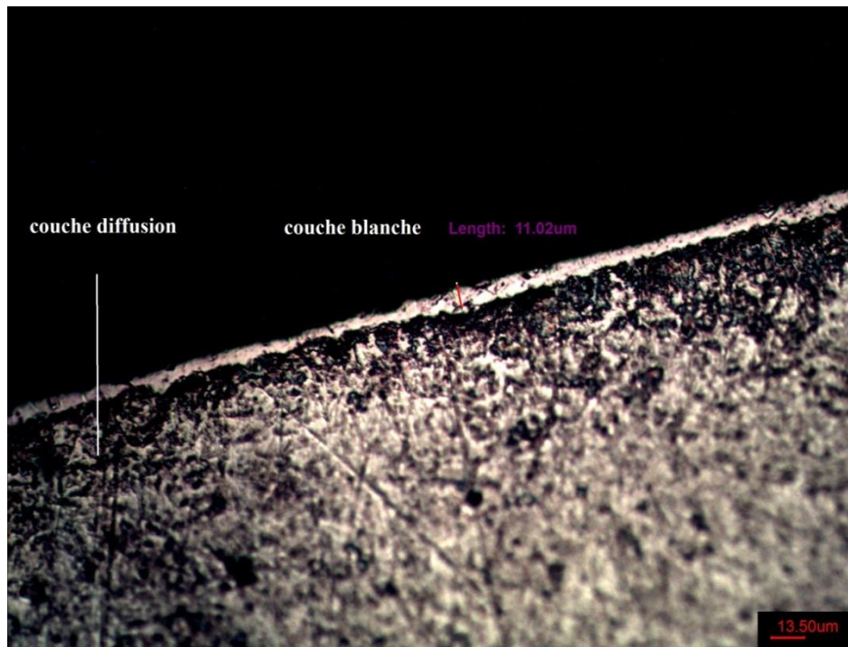
Figure 3-2- Micrographie optique d'une section droite de l'échantillon de l'acier 42CrMo4, nitruré à 550°C pendant 12 heures.
