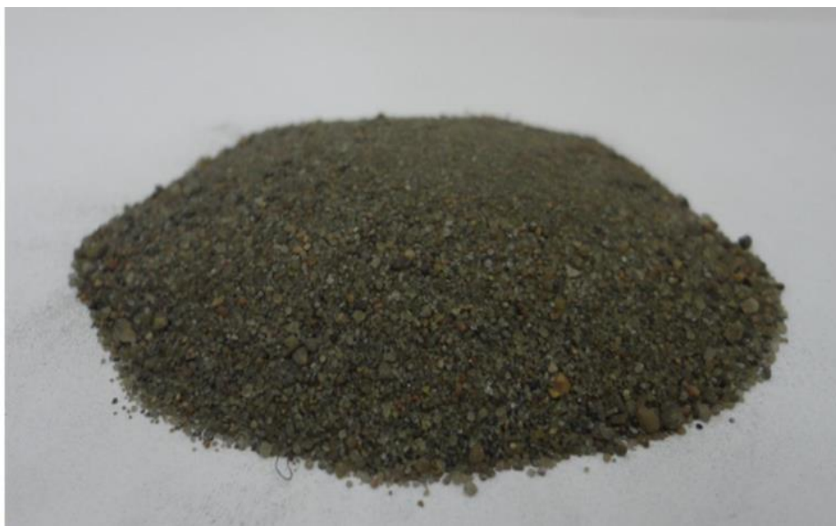
Figure 2-4- La poudre de bore-azote-carbone solide utilisée pour la nituration
