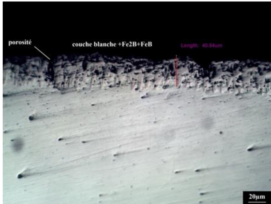
Figure 3-32- Micrographie optique d'échantillon de l'acier 55CrMoV4, nitruré à 550 °C pendant 12 heures et suivie de la boruration à 900 °C pendant 4 heures
