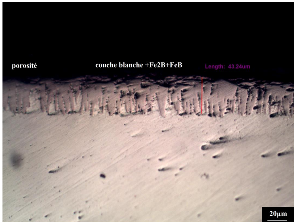
Figure 3-27- Micrographie optique de la section droite de l'échantillon de l'acier 55CrMoV4, boruré à 900 °C pendant 4 heures et suivie de la nitruration à 550 °C pendant 12 heures
