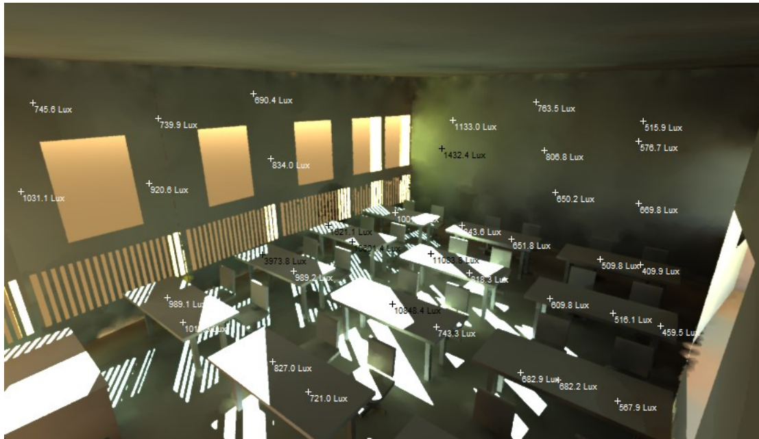
Figure 213: Mesure de niveau d'éclairément à ciel dégagé
