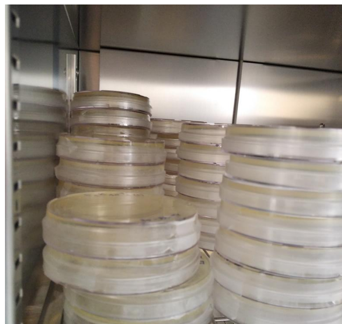
Photo 04. Les boit à la durée de l'incubation dans l'étuve à 27°C - 3 à 5 jours.
