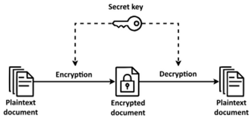
Figure 2 : Chiffrement à clé symétrique : la même clé est utilisée pour le chiffrement et le déchiffrement.
