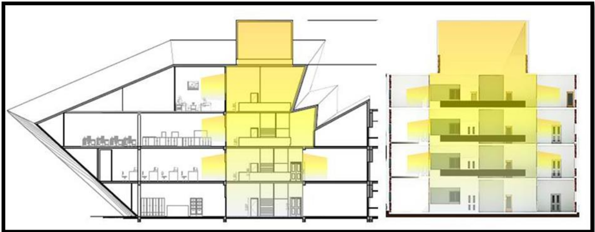
Figure V. 38 : coupe schématique présente l'adaptation des atriums. Source : auteur.
