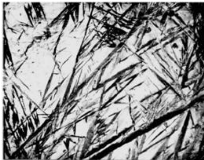
Figure. I.3 : acier de ferrite aciculaire
