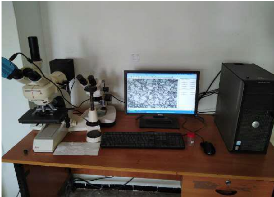
Figure. III.4 : Microscope optique de type LIECA DMLM (LGP)
