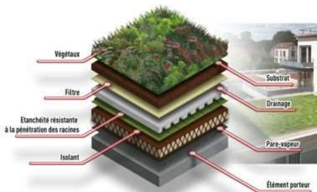
Figure I-36 : dispositif des toitures verte, (Source : Pinterest)
