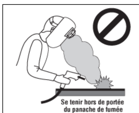
Figure VI-1 : position de soudeur par rapport au fumé Source : https://www.gazdetect.com
