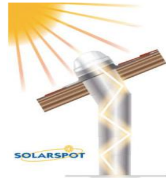
Figure 4 puits du jour
