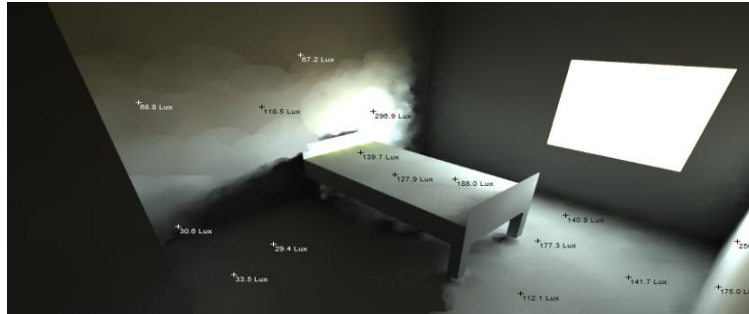
Figure 8: Niveau d'éclairage intérieure Source : auteur
