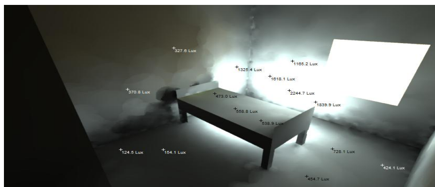
Figure 20: Niveau d'éclairage intérieure Source : auteur
