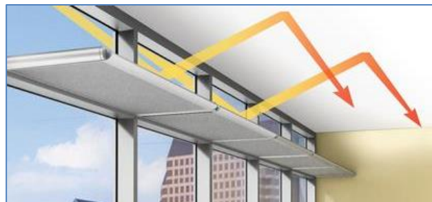
Figure 29 : les étagères, source: www.designingbuildings.co.uk
