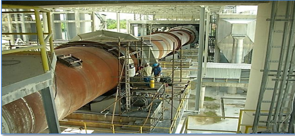
Figure I. 16 .Four de cuisson du gypse [7].
