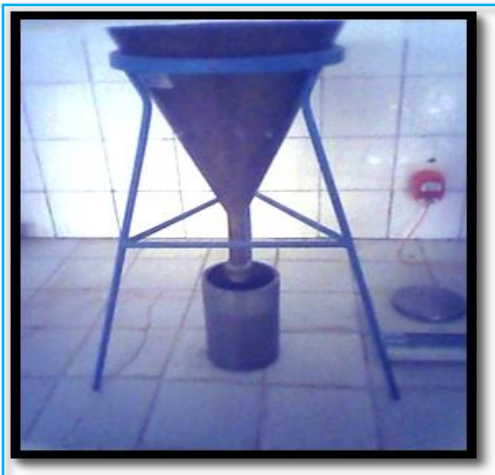
Figure III. 12. Dispositif pour l'essai de récipient et entonnoir à trépied.
