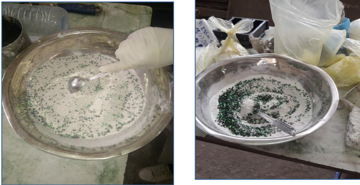
Figure III. 28. La procédure du malaxage.
