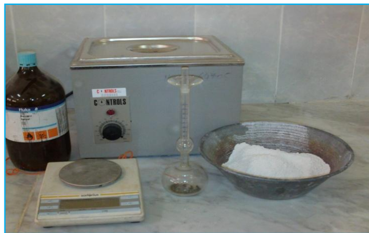
Figure III. 11. Équipement nécessaire pour l'essai de la masse volumique absolue du plâtre.
