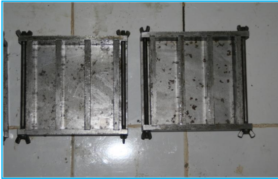
Figure III. 29. Moules utilisés pour l'essai mécanique
