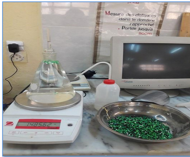
Figure III. 24.Détermination masse volumique absolue des déchets plastiques.
