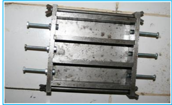
Figure III. 30. Moules utilisés pour l'essai de variation dimensionnelle.
