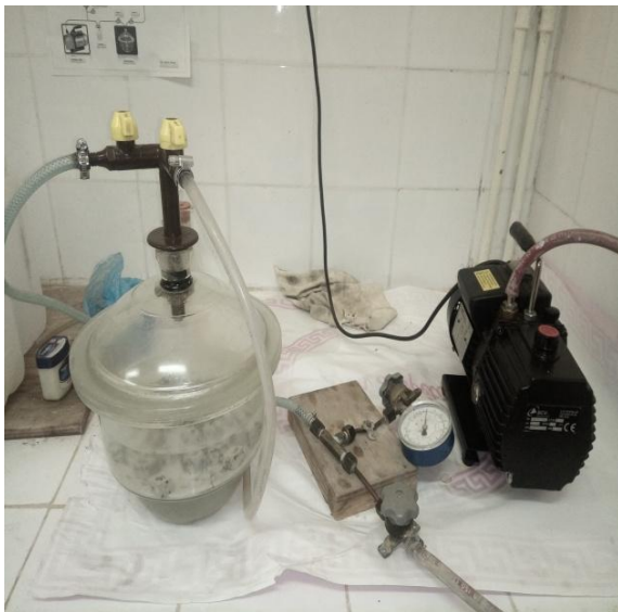
Figure B. 9. Dispositif et échantillon utilisés pour l'essai d'accessibilité à l'eau.
