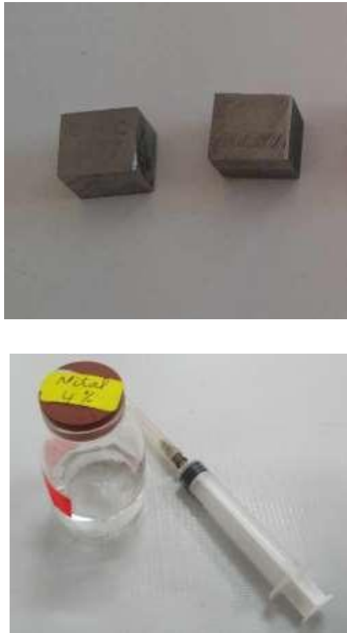
Figure 15 : échantillon après attaque chimique (Nital 4%)
