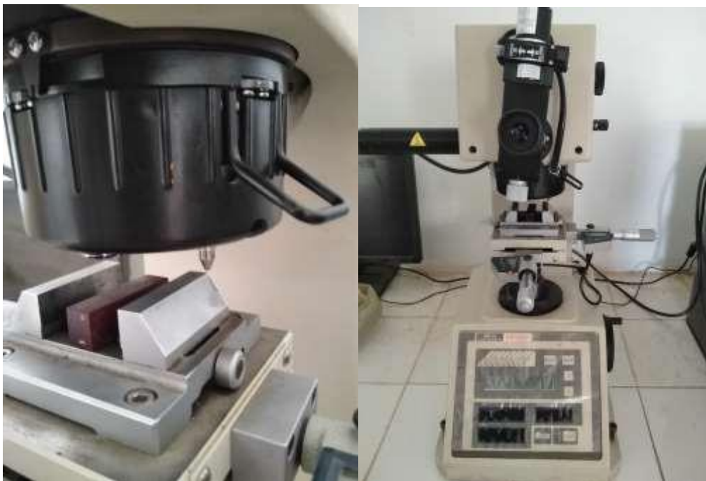
Figure 18 : Duromètre Model MVK-H2 (Hardness Testing Machine) (LGP).
