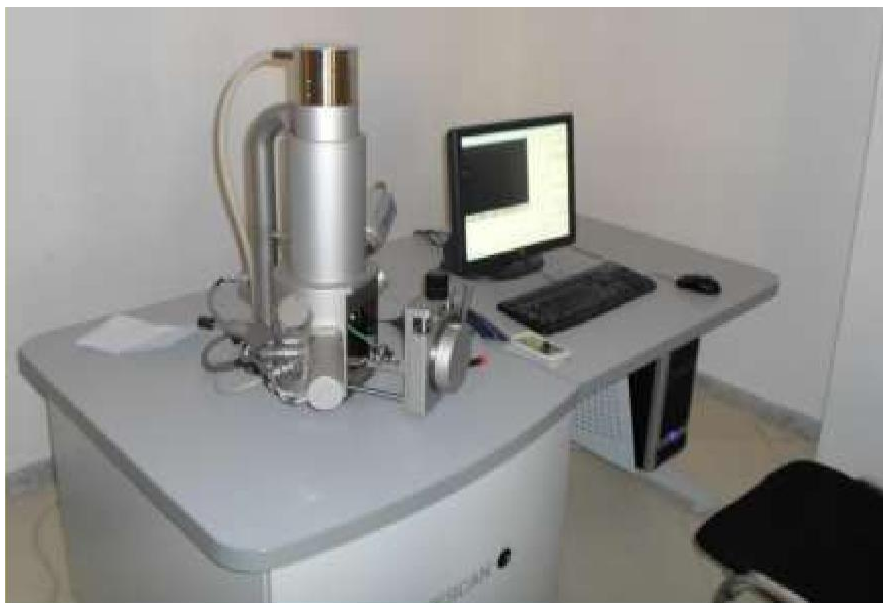
Figure 17 : Microscope électronique à balayage (TESCANVEGA3) (LGP)
