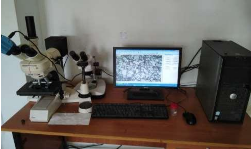
Figure 16 : Microscope optique de type LIECA DMLM (LGP)
